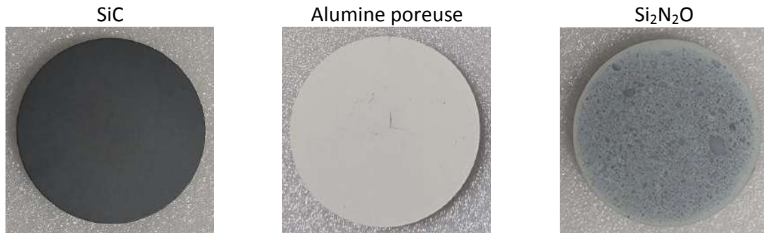
Figure 4 : Photographies des échantillons de carbure de silicium, alumine poreuse et d'oxynitride de silicium.
