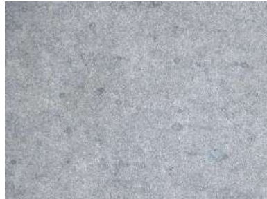
Figure 2 : image optique de l'APMT oxydé 50 h à 1100 °C (x50)
