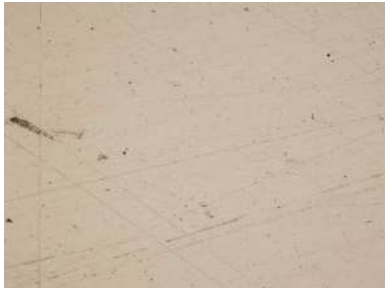
Figure 1 : image optique de l'APMT référence (x50)
